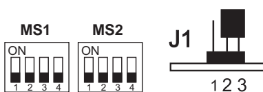
posizione dei microinterruttori MS1, MS2 e del ponticello J1 per uscire dalla fase di programmazione
