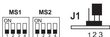
posição dos micro-interruptores MS1, MS2 e do jumper J1 para sair da fase de programação
