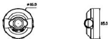
Fig. 12-c Blocco di protezione
