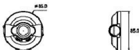
Fig. 13-c Blocco di protezione
